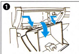
グローブボックスは両側にあるピンがストッパーとなっているので、そのピンが外れるように両側から強くグローブボックスを内側に押し込みます。ピンが外れたら、手前に引いて外します。
