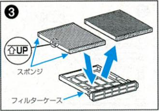
③ フィルターケースのツメ部から引き抜いて、フィルターを取り外し交換します。取り付ける際はUPマークが上向きになるように取り付けます。
