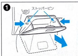
グローブボックスの側面を押さえながら上部のストッパーを片側ずつ外し、運転席側にあるダンパークリップを外してグローブボックスを手前に引いて外します。
