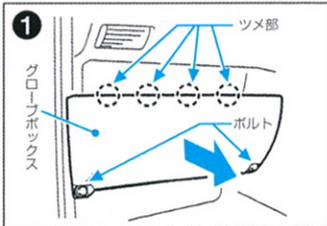
グローブボックスを閉じた状態で下にあるボルト2ヶ所を外し、上側ツメ部4ヶ所を外してグローブボックスを外します。
