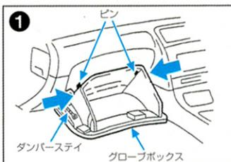
グローブボックスを開き、両端から押さえて上部のツメを片方ずつ外してからダンパーステーのピンを外し、グローブボックスを手前に引きながら取り外します。
