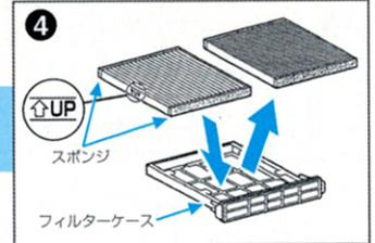
フィルターケースのツマミ部から引き抜いて、フィルターを取り外し交換します。取り付ける際はUPマークが上向きになるように取り付けます。
