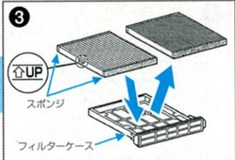
③ フィルターケースのツメ部から引き抜いて、フィルターを取り外し交換します。取り付ける際はUPマークが上向きになるように取り付けます。
