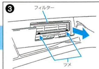
フィルターケース2ヶ所のツメを押してロックを外し、フィルターケースを引き出します。
