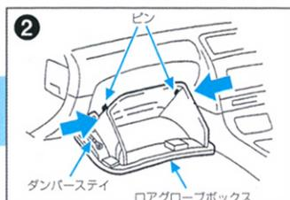
ダンパースティを外し、グローブボックスを外してください。ダンパースティはビスで止まっていますので、ドライバーで外します。
