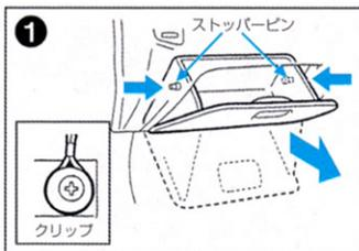
ダンパーステイのクリップを ⊕ドライバーなどで取り外し、グローブボックス両側を押さえながらストッパーピンを外します。
