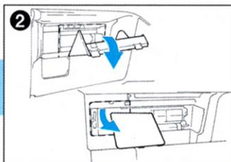
右側のパネルを外し、次に左側のパネルを外します。
