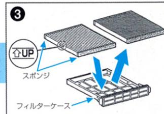
フィルターケースのツマミ部から引き抜いて、フィルターを取り外し交換します。取り付ける際はUPマークが上向きになるように取り付けます。
