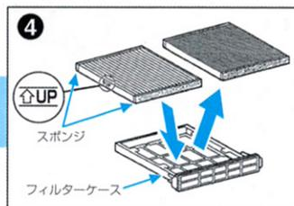
フィルターケースのツメ部から引き抜いて、フィルターを取り外し交換します。取り付けの際は↑UPマークが上向きになるように取り付けます。
