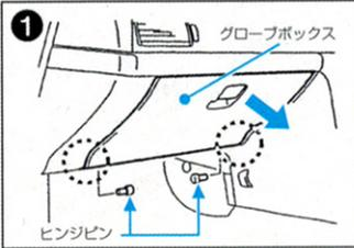
グローブボックスの下にあるヒンジピン2ヶ所を外し、グローブボックスを取り外します。
