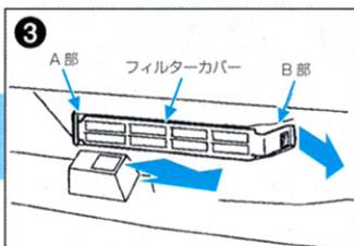
フィルターカバーB部をツメから外し、次にA部をガイドから抜きながら外します。
