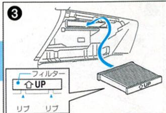
③ フィルターケースに取り付ける際、UPマークの向きに合わせて取り付けください。車種によってフィルターの挿入方向が異なりますのでご注意ください。
