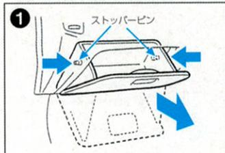
① グローブボックスの側面を押さながら上部のストッパーを片側ずつ外し、グローブボックスを手前に引いて取り外します。
