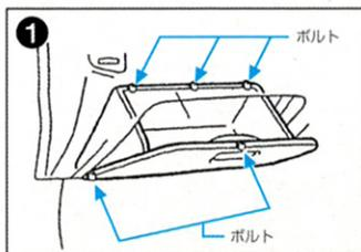
グローブボックスを開き4ヶ所のボルトを⊕ドライバーで外します。
