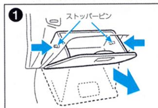
グローブボックスの側面を押さえながら上部のストッパーを片側ずつ外し、グローブボックスを手前に引いて取り外します。
