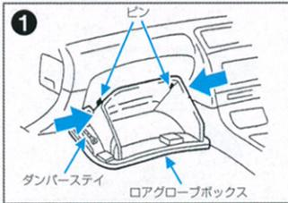
グローブボックスを開き、両端から押さえて上部のツメを片方ずつ外してからダンパーステイのピンを外し、グローブボックスを手前に引きながら取り外します。
