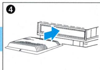
フィルターを取り外し交換します。取り付ける際はUPマークが上向きになるように取り付けます。
