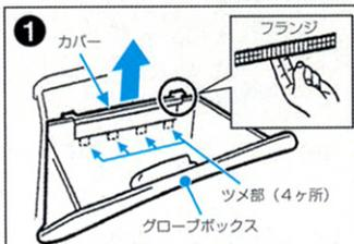
グローブボックス奥のカバーを上へ引き上げて外します。一部オプション装着の車はフィルターの装着が不可能です。
