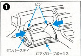
① グローブボックスを開き、両端から押さえて上部のツメを片方ずつ外してからダンパースティのピンを外し、グローブボックスを手前に引きながら取り外します。
