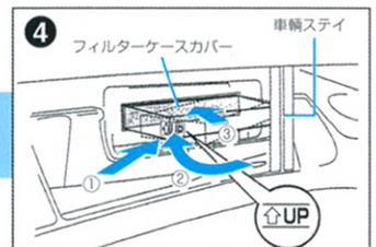
①フィルターを斜めにセットし、図の②の矢印方向に回転させながら、③取り付けます。↑UPマークの向きを上に合わせてください。
