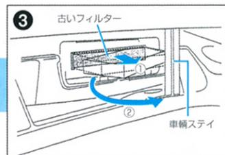
①フィルターを手前に引き出してから、図の②の矢印方向に回転させながら、フィルターを取り出します。
