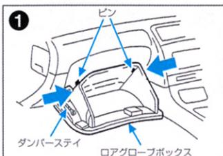
グローブボックスを開き、両端から押さえて上部のツメを片方ずつ外してからダンパースティのピンを外し、グローブボックスを手前に引きながら取り外します。
