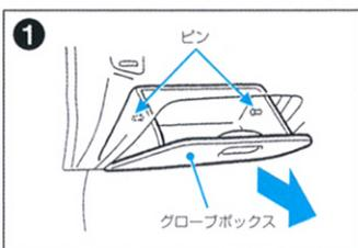
グローブボックスの両内側にあるピンを手前に回して引き抜き、グローブボックスを取り外します。
