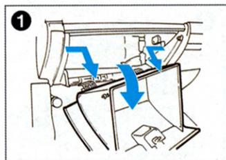
グローブボックスは両側にあるピンがストッパーとなっているので、そのピンが外れるように両側から強くグローブボックスを内側に押します。ピンが外れたら、手前に引いて外します。
