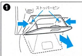
グローブボックスの側面を押さえながら上部のストッパーを片側ずつ外し、グローブボックスを手前に引いて外します。
