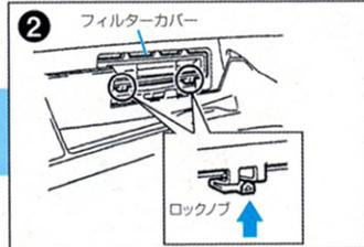
フィルターカバーのロックノブを上へあげ、ロックを解除して、フィルターカバーを手前に引いて外します。
