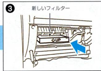
フィルターケースにフィルターを取り付けます。取り付ける際はフィルター側部表示のUPマークの向きを上に向けて装着してください。
