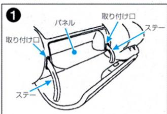
グローブボックスを中間位置まで持ち上げながら、ステーを同時に引き上げて取り付け口から外した後、グローブボックス全体を手前に引いて取り外します。
