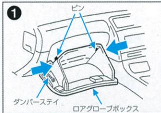
グローブボックスを開き、両端から押さえて上部のツメを片方ずつ外してからダンパーステイを外し、グローブボックス全体を引き上げて取り外します。
