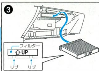
フィルターケースに取り付ける際、UPマークの向きに合わせて取り付けてください。車種によってフィルターの挿入方向が異なりますのでご注意ください。
