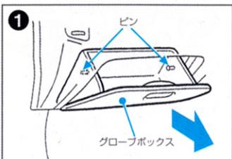
グローブボックスの両内側にあるピンを手前に回して引き抜き、グローブボックスを取り外します。
