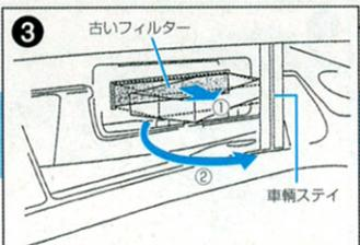
③ 古いフィルターを手前に引き出してから、図の②の矢印方向に回転させながら、フィルターを取り出します。
