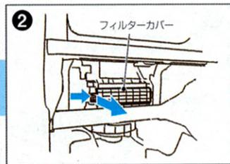
フィルターカバー左側にツメがありますので、ツメを外し、フィルターカバーを外します。
