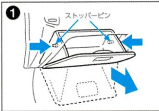
グローブボックスの側面を押さえながら上部のストッパーを片側ずつ外し、グローブボックスを手前に引いて外します。
