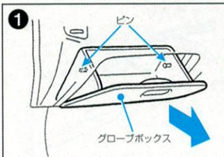
グローブボックスの両内側にあるピンを手前に回して引き抜き、グローブボックスを取り外します。'03.08以降はダンパーステーを外してグローブボックスを外します。
