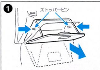
グローブボックスの側面を押さえながら上部のツメを片側ずつ外し、グローブボックスを手前に引いて取り外します。
