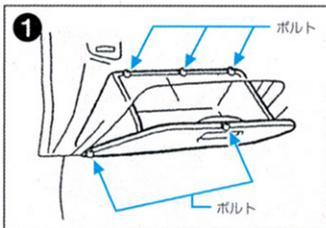
グローブボックスを開き5ヶ所のボルトを ⊕ドライバーで外します。
