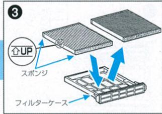
フィルターケースのツメ部から引き抜いて、フィルターを取り外し交換します。取り付ける際はUPマークが上向きになるように取り付けます。
