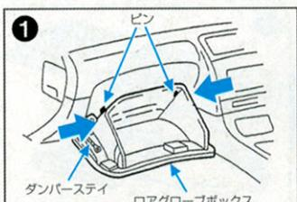
① グローブボックスを開き、両端から押さえて上部のツメを片方ずつ外してからダンパースティのピンを外し、グローブボックスを手前に引きながら取り外します。
