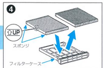
フィルターケースのツメ部から引き抜いて、フィルターを取り外し交換します。取り付ける際は↑UPマークが上向きになるように取り付けます。
