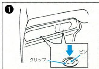
助手席側パネルのトレイにあるクリップを取り外します。クリップの中心にあるピンを「カチッ」と音が出るまで押してクリップを外します。
